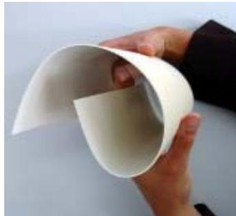
ist eine dünne, flexible Porzellan-Folie, basierend auf keramischen Rohstoffen und einer organischen Bindematrix. Aufgrund der hohen Flexibilität der Folie ergeben sich völlig neue Möglichkeiten in der Porzellanverarbeitung:
